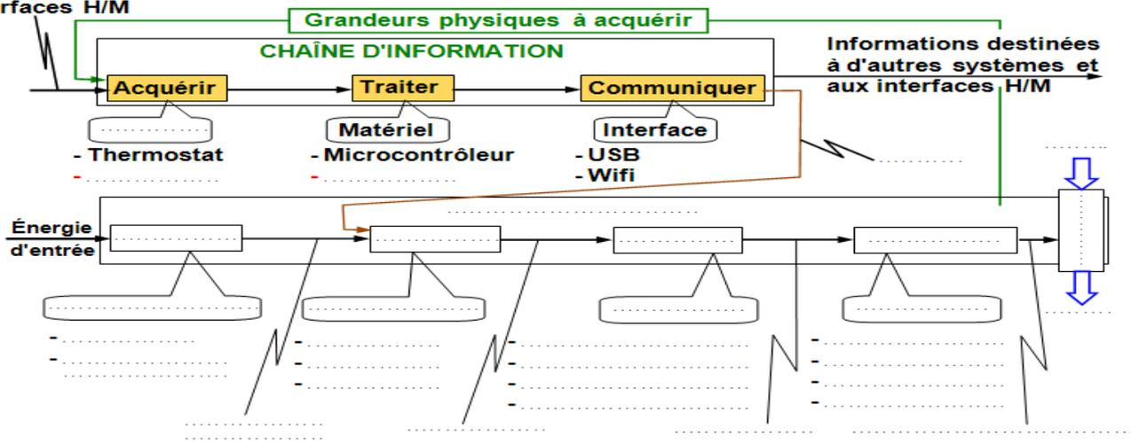
CHAÎNE D'ÉNERGIE : FONCTION GÉNÉRIQUE ALIMENTER EN ÉNERGIE
